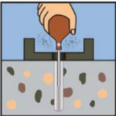
Bohrmehl entfernen, z.B. durch ausblasen
