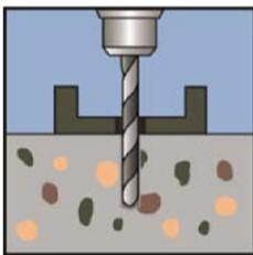
Bohrloch dreh-schlagend bis zur erforderlichen Bohrlochtiefe erstellen
