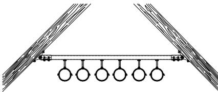
Montage d'une nappe sous une toiture
