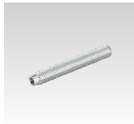
Ankerstange für Voll- und Lochstein Typ VMU-IG, Festigkeitsklasse 5.8
