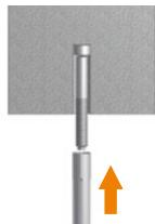
DE Spreizhülse auf den Konusbolzen bis Anschlag einschieben
