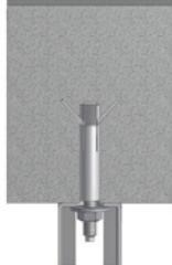
DE 6-Kant Mutter mit Drehmoment vorspannen (siehe Tabelle). Der Dübel ist ordnungsgemäß verankert wenn der blaue Kontrollring sichtbar wird
