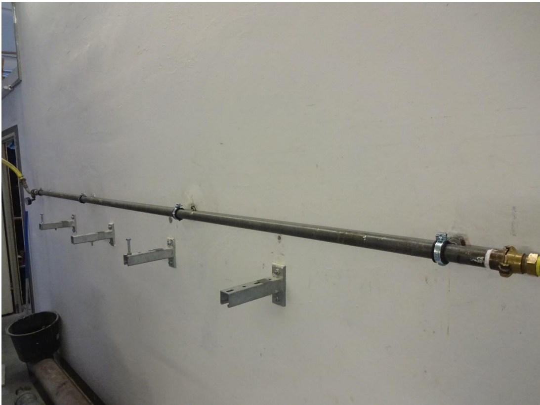
Bild 2: Messung 1: OPTIMAL JUNIOR EASY mit Einlage aus DÄMMGULAST®, 1" (32 - 35 mm), Anschluss M8
