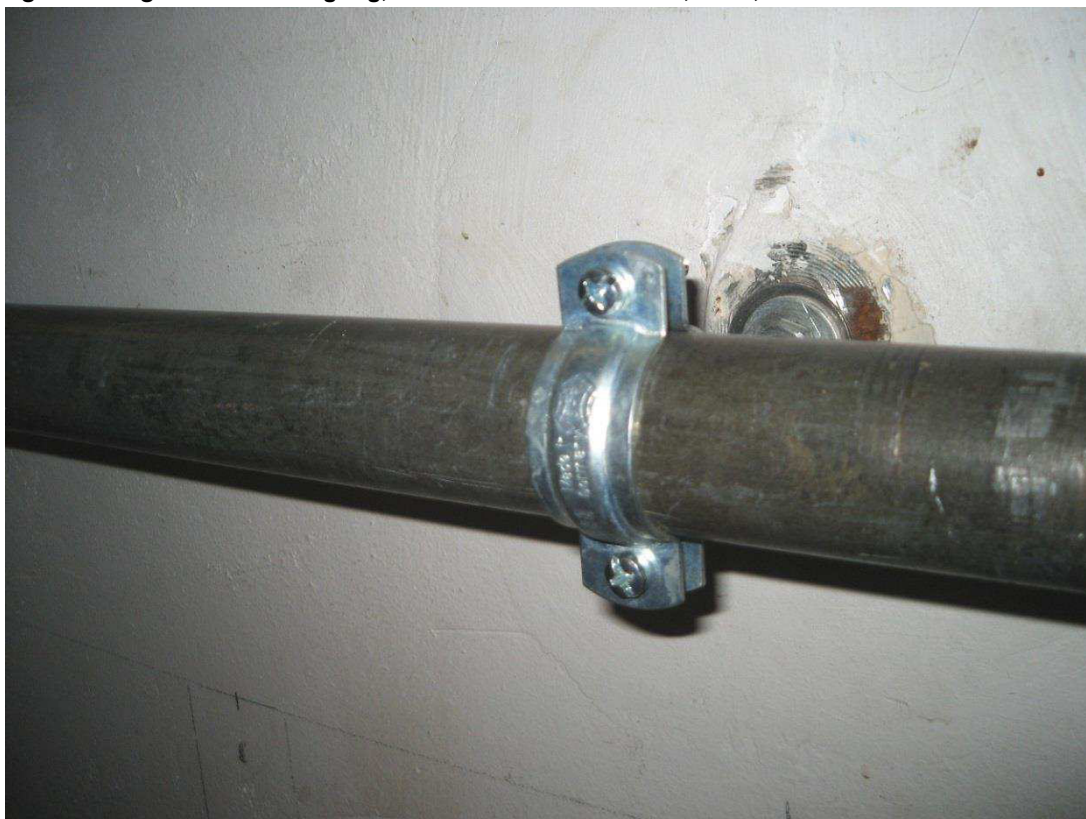
Bild 1: Bezugsmessung: starre Befestigung, Prüfrohr Durchmesser 33,7 mm, 1"
