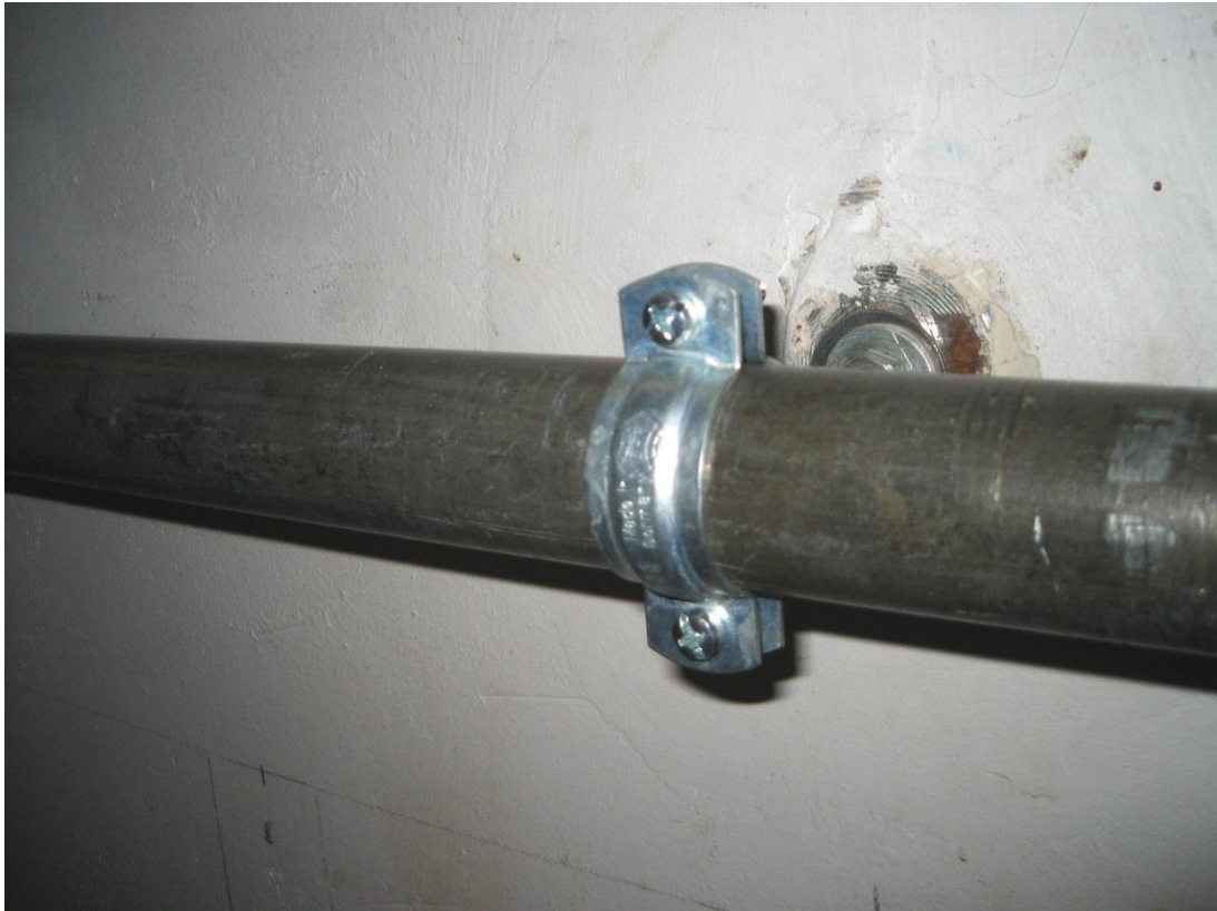
Bild 1: Bezugsmessung: starre Befestigung, Prüfrohr Durchmesser 33,7 mm, 1"
